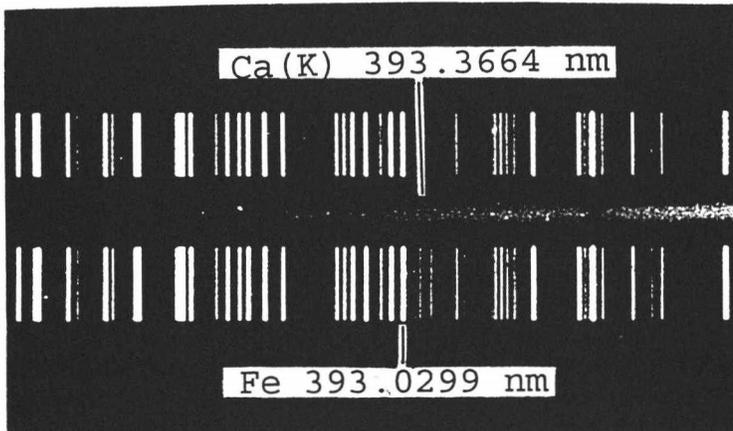
Bild 5 Vergrößerter Ausschnitt aus einem der Originalspektren des Sterns  $\delta$  Orionis. Markiert sind die schwache interstellare CaII-Linie und eine Linie des Eisenlichtbogens zum Wellenlängenanschluß. Plattenarchiv des AOP
